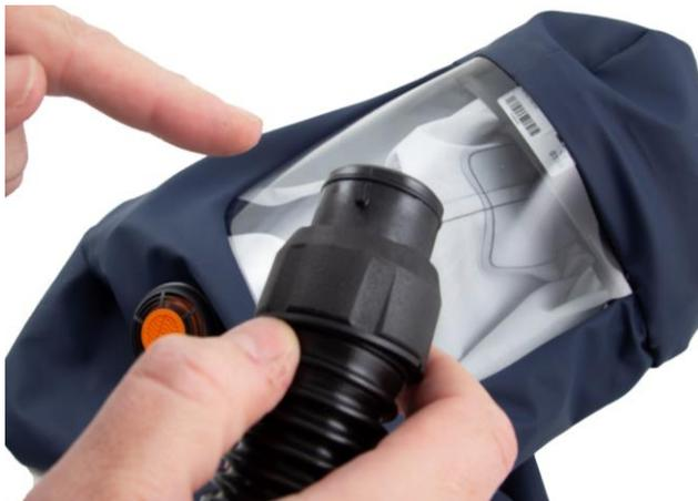
**1.2** Kontrolliere dass der O-ring des Schlauches richtig montiert und unbeschädigt ist.
