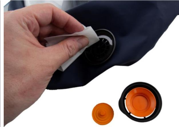
**6.5** Reinige die Ventilsitz und kontrolliere dass es sauber und unbeschädigt ist.
