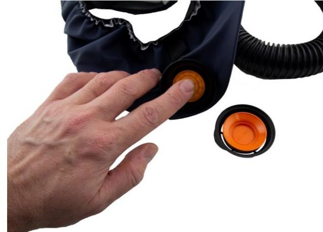
**4.3** Neue Membrane am Zapfen befestigen. Genau darauf achten, dass die Membrane am Ventilsitz rundum anliegt.
